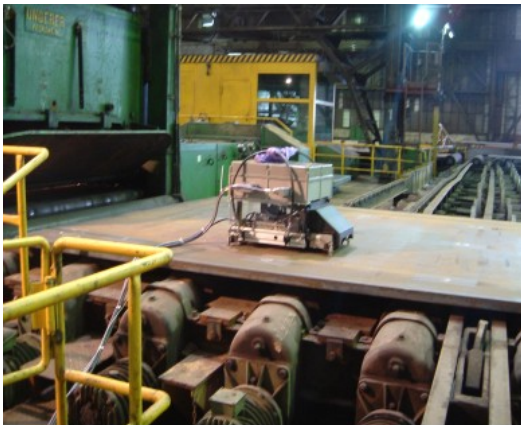
Bild 2: Transportwagen für die halbautomatische Prüfung von Walztafeln
