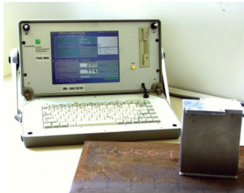
Bild 1: 3MA-Prüfsystem mit Sensor
