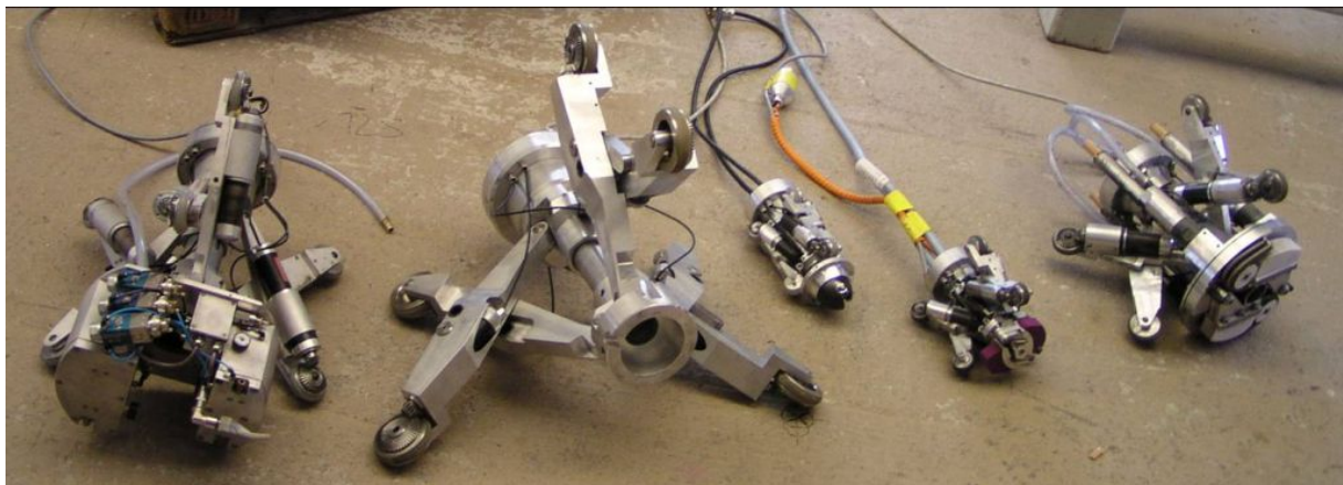
Abb. 3: Überblick über einige Baugrößen (DN150 bis DN700) von Scherenmolchen
