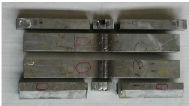
Abb. 1: Eine der geschweißten Platten zerlegt in zwei Ultraschallproben (in Bildmitte horizontal liegend) und zwei Metallografieproben (kurze Probenstücke mittig oben und unten)
