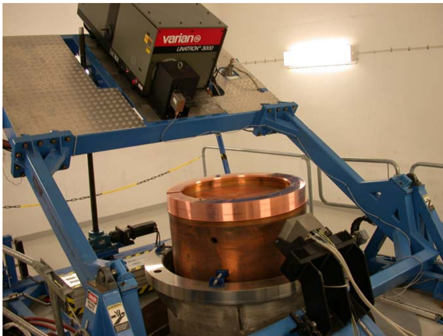
Abb 2: Durchstrahlungseinrichtung für zylindrische Behälter. Die umlaufende Deckelverschweißung wird bei rotierendem Behälter mittels einer Zeilenkamera abgescannt.
