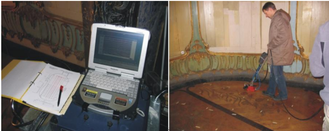
Abbildung 8: links: Radarausrüstung (GSSI), rechts: Messung mit 1,5 GHz Antenne (GSSI)
