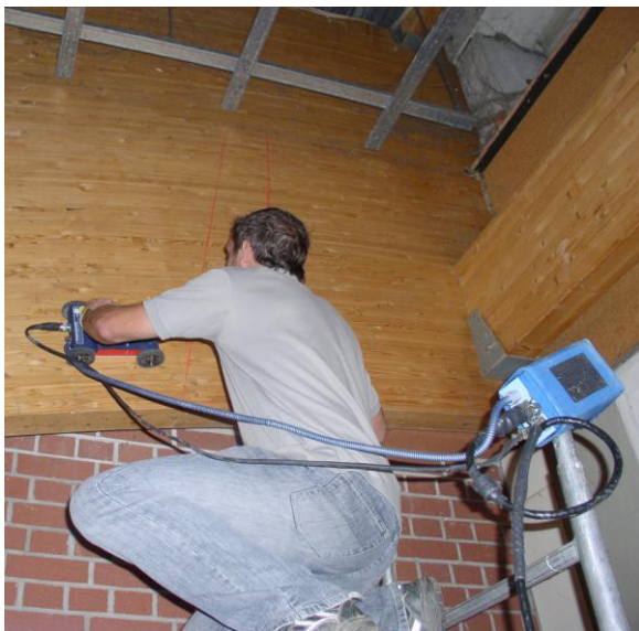
Abbildung 2: Radarmessung an BSH-Binder
