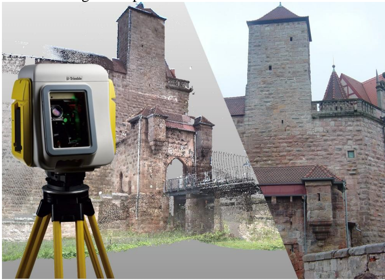
Abbildung 2: 3D-Laserscanner , links Laserbild, rechts Foto
