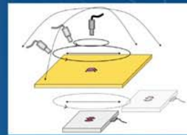
Prinzip einer Laminografiemessung
