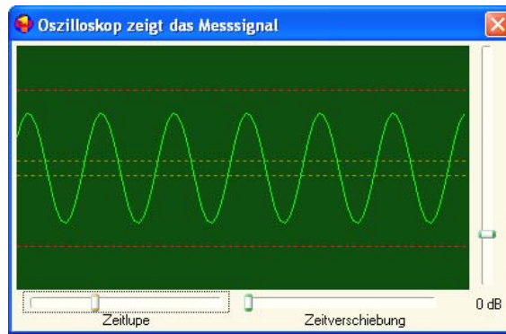
Bild 11: Das Messsignal vor der Demodulation. Aus ihm werden der Real- und der Imaginärteil für die Anzeige gewonnen
