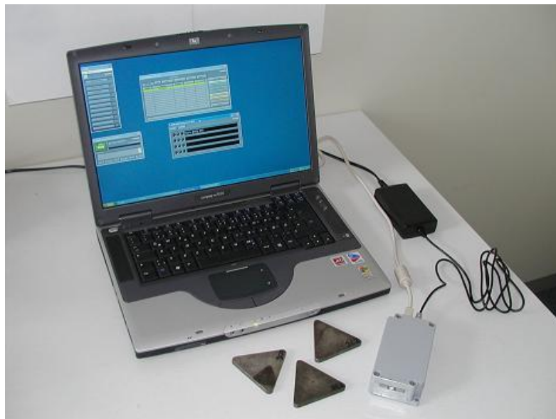
Abbildung 1 MikroMach – Prüfgerät (grau) mit Netzteil zur Spannungsversorgung und PC zur Daten auswertung
