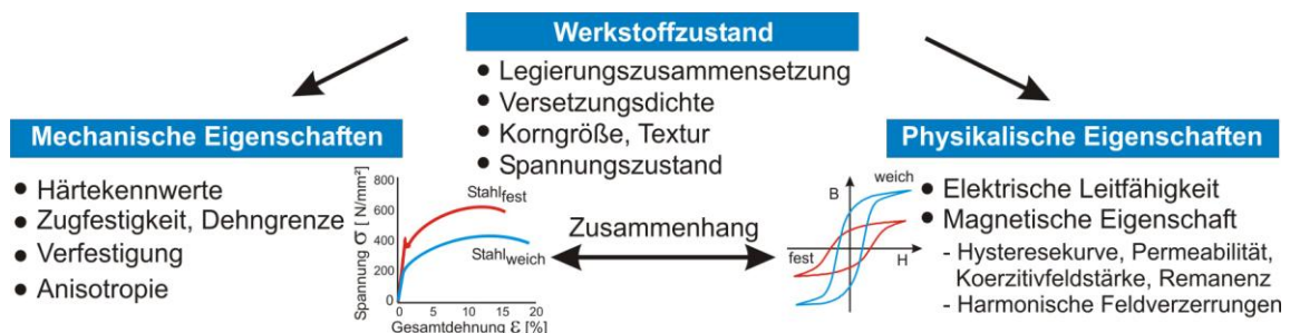
Bild 1: Indirekte Bestimmung mechanischer Bauteileigenschaften
