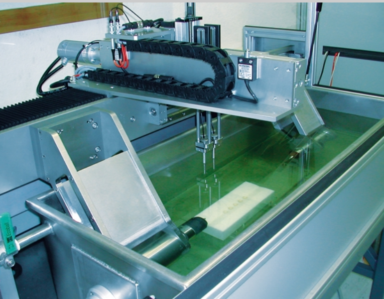
Abb. 2-kanalige Prüfanlage zur Qualitäts- und Reinheitsgradprüfung von Stahlproben
