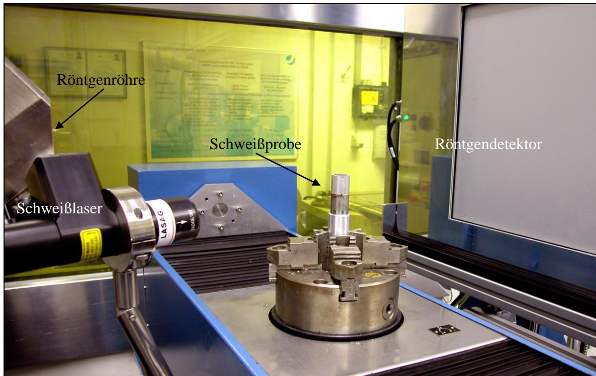
Bild 1: Röntgensystem mit Schweißlaser
