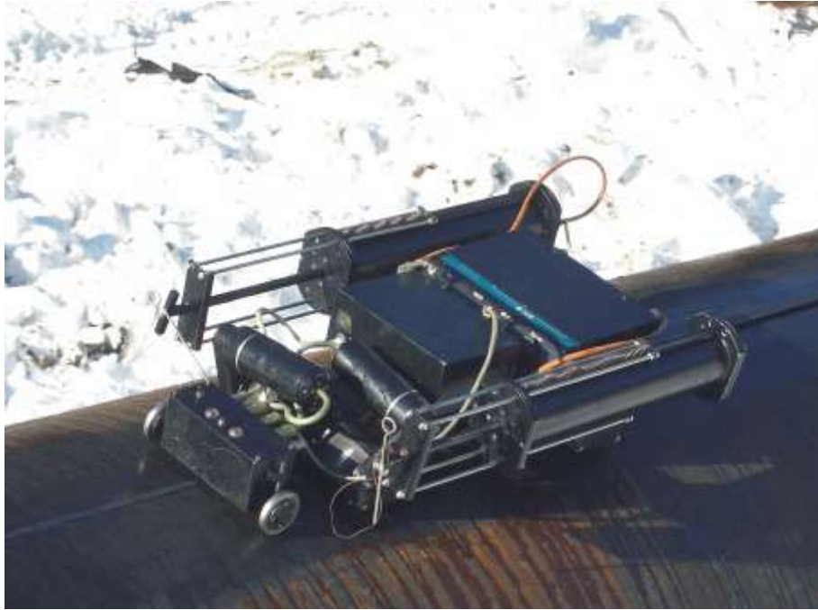
Abbildung 1: Scanner-Roboter "Autokon-MGTU" für automatisierte Ultraschallprüfung.
