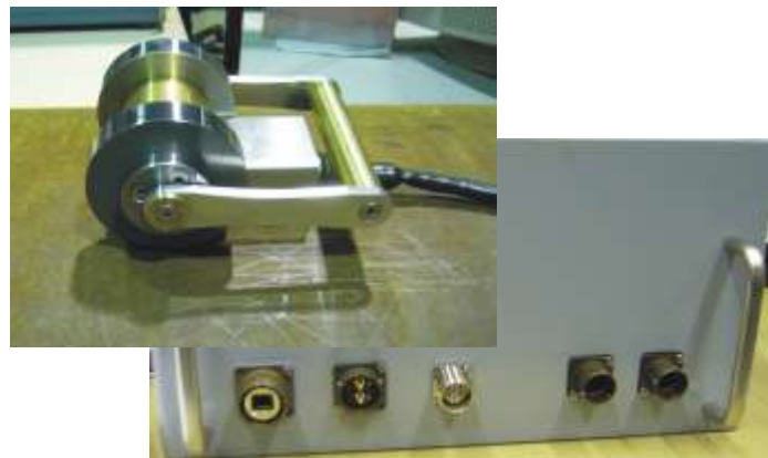
Abbildung 7: EMUS-Sensorprototyp und EMUS-Frontend-Elektronik im wasserdichten Gehäuse.
