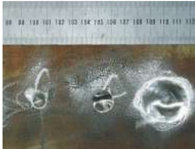
Abbildung 9: Kalottenförmiger Fehler an der Innenseite, Durchmesser 10 mm, Tiefe 3 mm. Das Ultraschall- A -Bild bei einer Entfernung von 270 mm.
