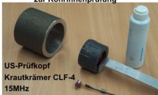
Abbildung 3: Ultraschallprüfung 8" Rohr - Fehlertiefe über Rohrinnenwand
