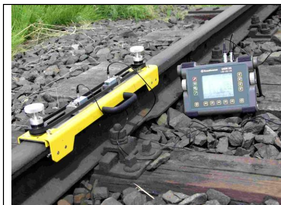
Bild 17: Tandemhalterung für Schienenschweißungen - vertikal
