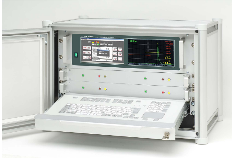
Bild 1: Beispiel für eine ECHOGRAPH 1093-Prüfelektronik mit vier Prüfkanälen, realisiert in Form von zwei Doppel-Ultraschallkarten. Ein PC-Modul dient der Steuerung der Gesamtanlage. Ein A-Bild-Modul stellt die Ultraschallsignale dar.
