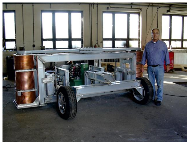
Abb. 7: Der elektromagnetische Jochmagnet, integriert im Fahrzeug mit elektrohydraulischem Antrieb [Firma HFB Fahrzeugbau & Service GmbH Müncheberg]
