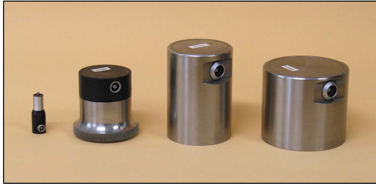
Bild 2. Verwendete Prüfköpfe (von links nach rechts): T 1802 (Transversalwellen), S 40 HB 0,2–0,6, G 0,2 R4, G 0,2 RC 75B (alle Longitudinalwellen)
