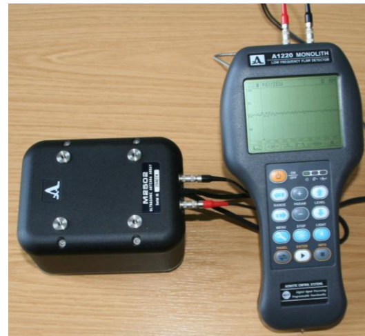
Abbildung 4: Handgerät hier mit Transversalwellen-Sende-Empfangseinheit A1220 der Firma Spectrum.
