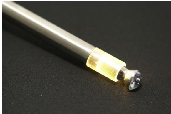
Bild 6: Retro-Rundumblick Endoskop mit Greguss-Linse
