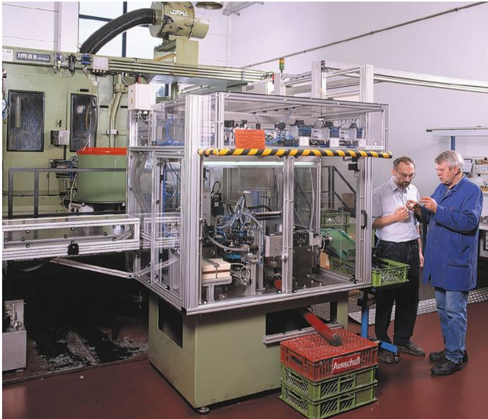
Bild 1: Das Prüfsystem PanCam eingebunden in einen voll verketteten Fertigungsprozess.
