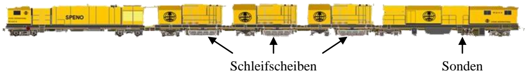
Abbildung 9. Lage der Schleifscheiben und Wirbelstromsonden.
