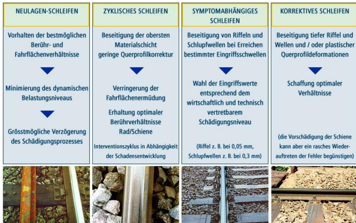
Abbildung 1. Arten des Schienenschleifens (Quelle: SPENO International SA).
