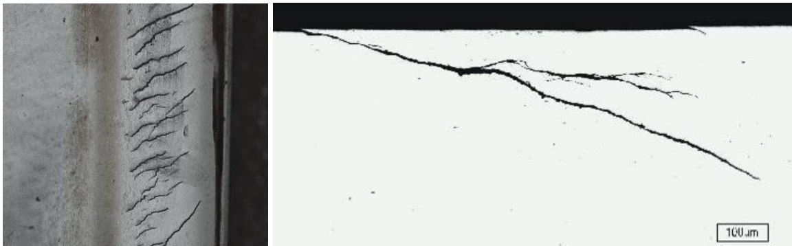
Abbildung 2. Head Checks: Magnetpulveranzeige (links) und Schliffbild (rechts).
