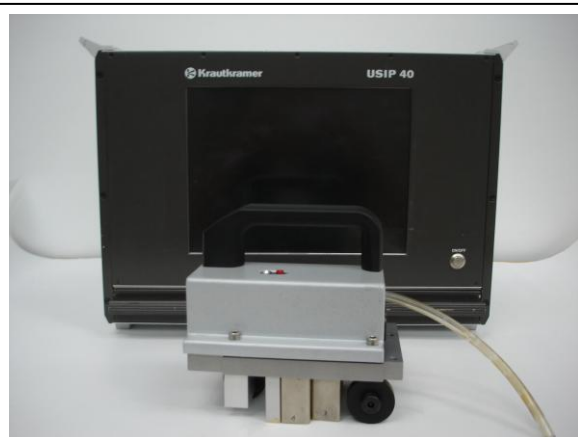
Abb. 6: Ultraschallgerät und Scannereinheit für teilautomatisierte Prüfung
