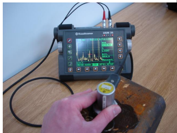
Abb. 4: Ultraschallgerät und SE-Prüfkopf für die manuelle Prüfung
