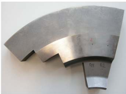
Bild 3: Ausschnitt einer geschmiedeten Laufscheibe aus Ti6246 zur Evaluation möglicher Ultraschallprüfverfahren. Dieser Testkörper enthält mehrere Sacklochbohrungen, von denen sich zwei in einem stark umgeformten Bereich der Scheibe befinden. Die kleinere dieser Bohrungen hat einen Durchmesser von 192 µm.
