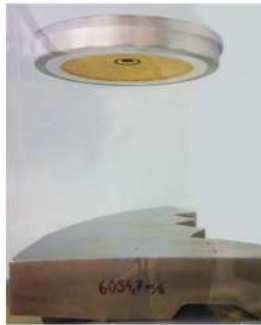
Bild 4: Test des Annular Phased Arrays-Prüfkopfs am Turbinenscheiben-Testkörper im Wasserbad.
