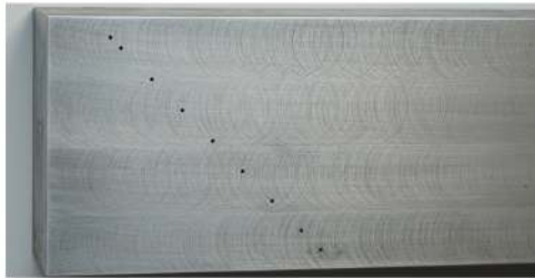
Bild 1: Stahltestkörper (125 mm hoch) mit Querbohrungen in unterschiedlichen Tiefen. Der Durchmesser der Bohrungen beträgt etwa 2 mm.
