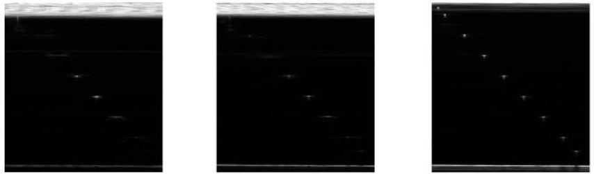
Bild 2: B-Bilder des Stahlkörpers mit Querbohrungen (Bild 1) für verschiedene Fokussierungsmodi. Bei der klassischen Variante (links) wurde auf eine Tiefe von 75 mm fokussiert, mit denselben Verzögerungszeiten sowohl für die Sende- als auch für die Empfangssignale. Im mittleren Bild wurde mit einem »Besselstrahl« gesendet und empfangsseitig auf eine Tiefe von 75 mm fokussiert. Im rechten Bild wurde mit einem »Besselstrahl« gesendet und die empfangenen Signale dynamisch tiefenfokussiert (DDF).
