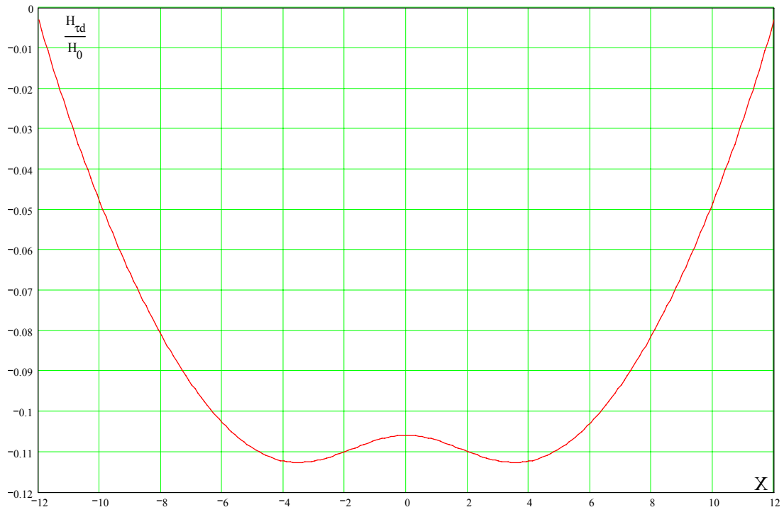
Fig.5. When t=17\text{mm} , b=12\text{ mm} , c=2.5\text{ mm} , \delta=2.5\text{mm} , h=5\text{ mm} , \mu=240 , a=1.5\text{ mm} , d=0 .
