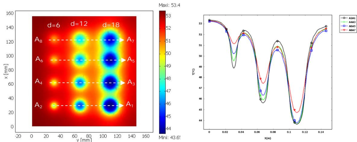
**Figure 7.** Influence of defect diameter on the entry surface temperature profile along the lines  $d=6, 12, \text{ et } 18\text{mm}$ ; (O :  $A_2A_1$ ,  $l_1=1\text{mm}$ ); (+ :  $A_4A_3$ ,  $l_1=2\text{mm}$ ); ( $\square$  :  $A_6A_5$ ,  $l_1=3\text{mm}$ ); ( $\nabla$  :  $A_8A_7$ ,  $l_1=4\text{mm}$ )
