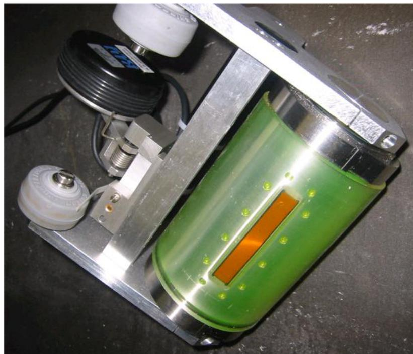
Fig. 21: R/D-Tech Wheel Probe
