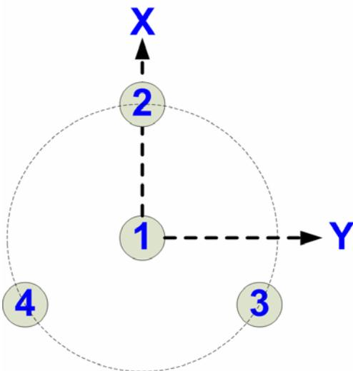
**Fig. 4:** MUSA sensor pos. top view
