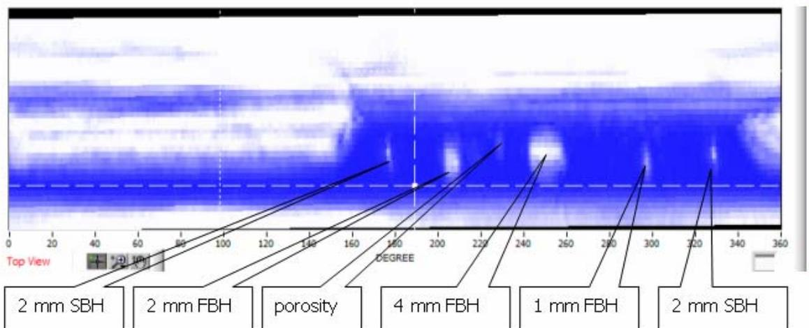
Fig. 8 : Amplitude top view
