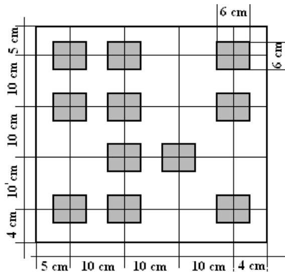
Fig. 3: Diagram of etalon.
