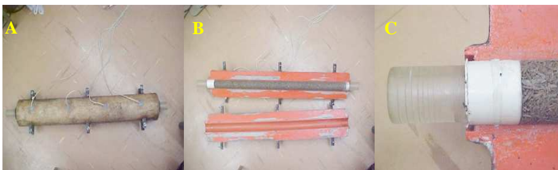
Figura 1. (A) - Unidad termo-sónica (UTS); (B) Detalle de la probeta cilíndrica en el interior del equipo; (C) Detalle del sistema de acoplamiento del ultrasonido.
