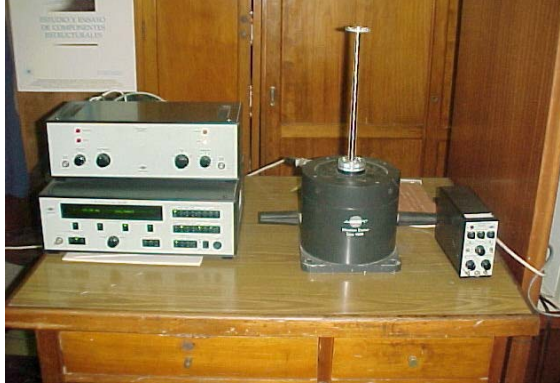
Figura 18: Ensayo de vibraciones en eje longitudinal
