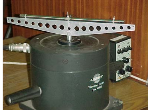
Figura 19: Ensayo de vibraciones en eje radial
