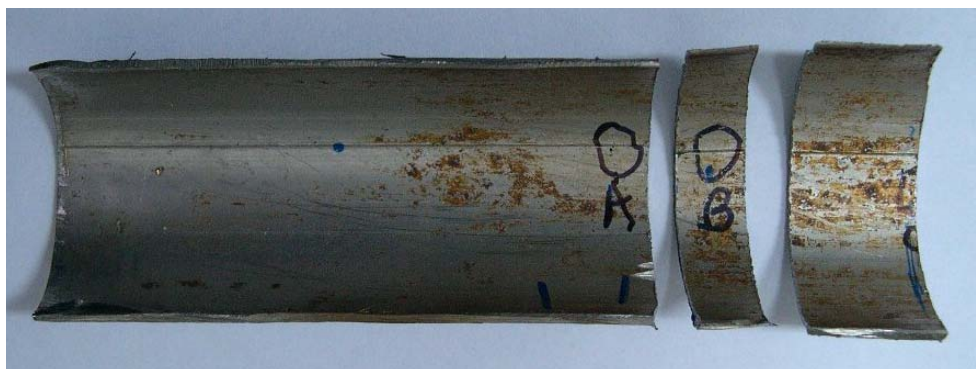
Figura 8. Tramos iniciales del tubo defectos identificados como A, B y C
