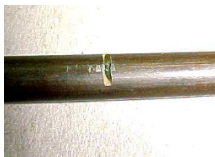
Figura 7: varilla con ranura de 1,5 mm de profundidad.
