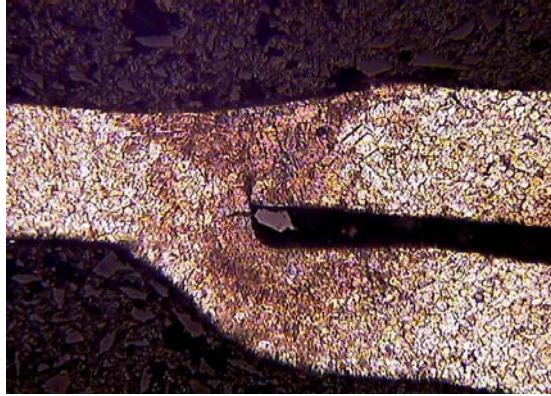
Figura 4 - Metalografía de un perfil de soldadura.
