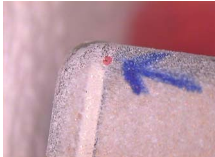
Fig 9 – Defecto pasante detectado mediante el ensayo de tintas
