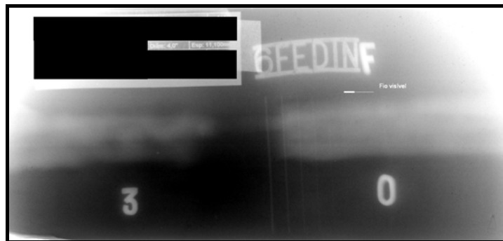
Figura 14 – Radiografia convencional digitalizada – Φ4” x 11,10 mm
