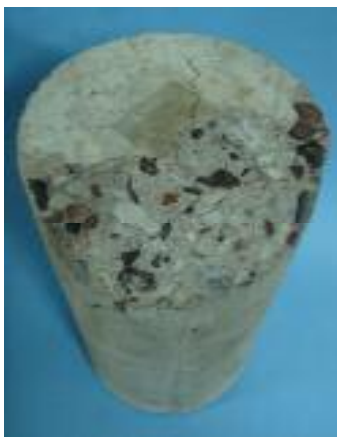
Figura 3. Aspecto de una de las probetas con relación a/c = 0,55, enfriadas al aire y expuesta a 750 °C.
