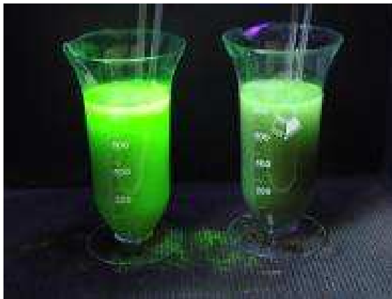
Figura 5: Foto comparativa de banhos com partícula magnética fluorescente onde ocorreu perda da fluorescência.
