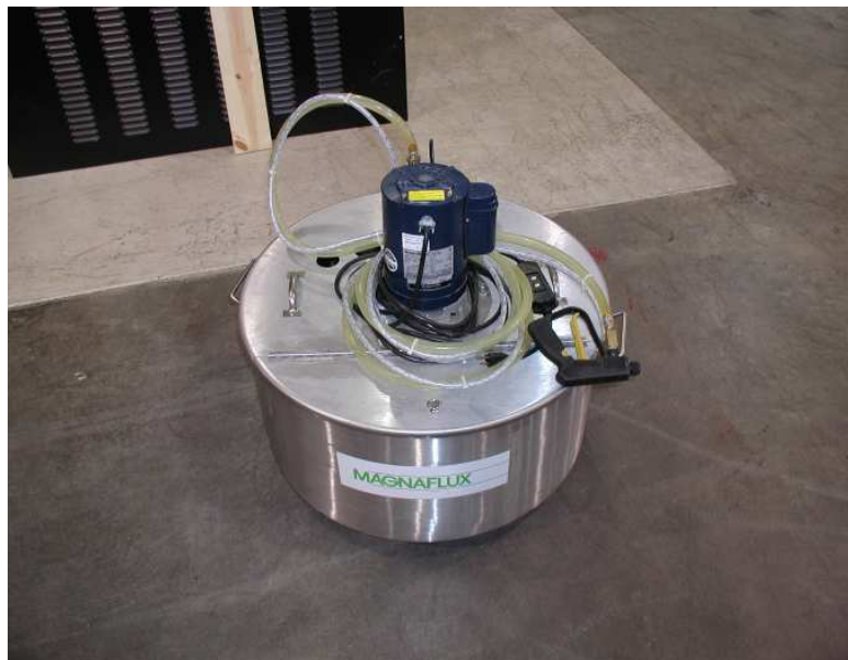
Figura 2: Foto ilustrativa de tanque de armazenamento de banho de partículas magnéticas com sistema de agitação e bombeamento constantes [6].
