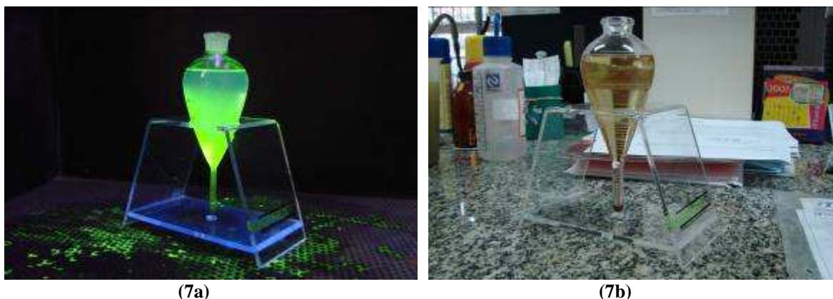
Figura 6: Verificação de concentração pelo tubo de decantação. Fluorescente (7a) e visível (7b).
