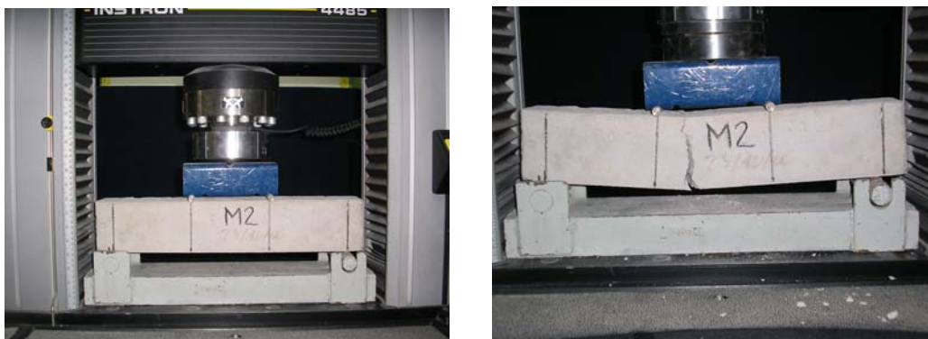
Figuras 6: Configuración de ensayo a flexión, probetas prismáticas
