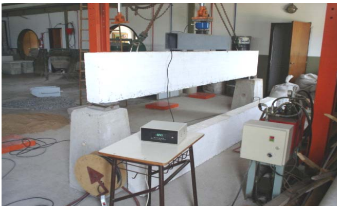
Figura 1: Adquisidor de datos de carga y central de control de actuadores hidráulicos
