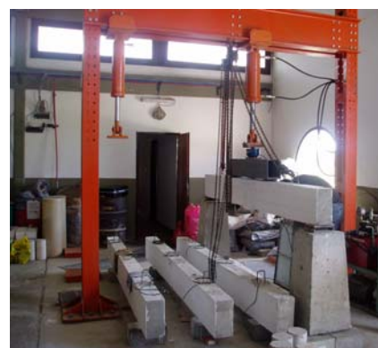
Figura 2: Marco de carga y configuración de ensayo
