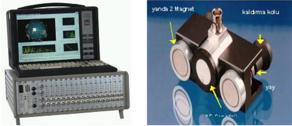
Şekil 9. Vallen AMSY-5 AE sistemi ve algılayıcı düzeneği
