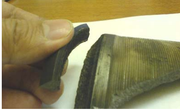
Şekil 2. Yapılan testlerde kırılmış silindir gömleği
