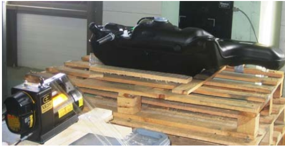
Şekil 9 Radyografik çekim düzeni.
