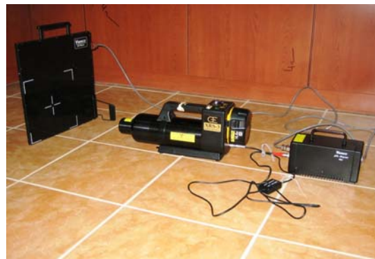
Őekil 2 X iŐını tp Flat Panel ve ICU baęlantısı
