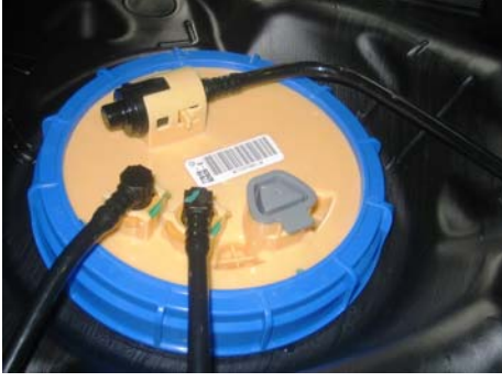
Şekil 6 Otomobilin torklanarak kapatılmış yakıt tankı kapağı. Şekil 7 Yakıt tankı içine yerleştirilen modül.
