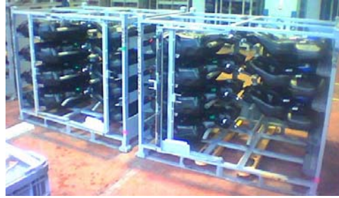
Şekil 4 Otomobillere monte edilmek üzere otomobil montaj fabrikasına sevk edilen yakıt tankları.
