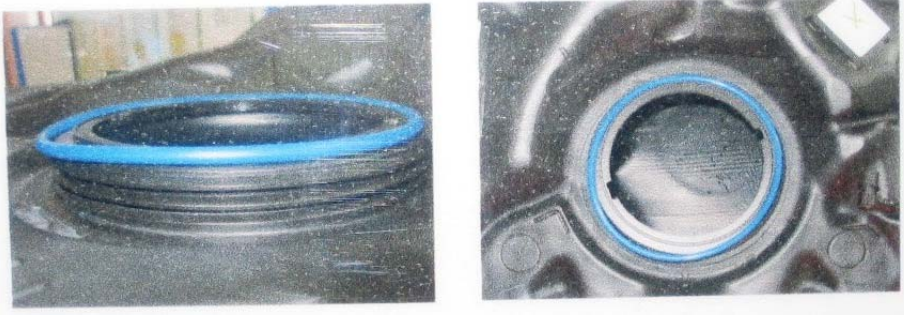
Şekil 5 O-ring contanın yakıt tankının ağzına düzgün olmayan yerleşimi.
