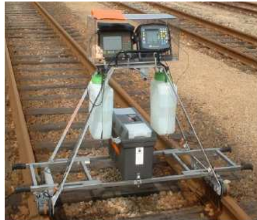
Şekil 4. Rayın Ultrasonik Muayenesi (Solda otomatik, sağda manuel)
