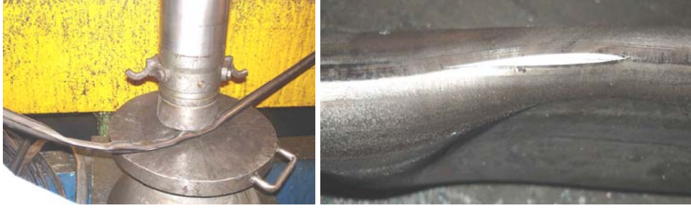
Resim 2. Yassılma testi ile kaynak dikişinin tahribatlı muayenesi
