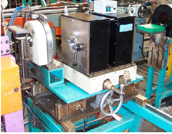
Resim 5.a) Offline dairesel bobin test sistemi b) Offline kombine test sistemi
