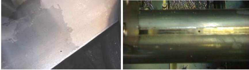
Resim 6. Online kontrollerde a) bant ve b) boru üzerinde kalibrasyon delikleri
