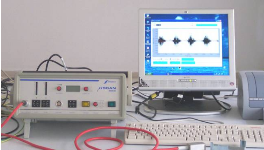
Şekil.5. Manyetik Barkhausen Gürültüsü Ölçüm Cihazı
