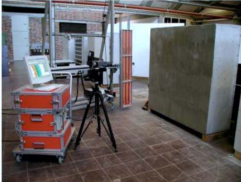
Abbildung 1: Experimenteller Versuchsaufbau für die Impuls-Thermografie und die PPT.
