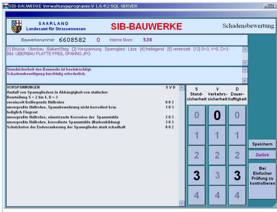
Bild 3.3: Dreistufige Schadensbewertung mit SIB – Bauwerke
