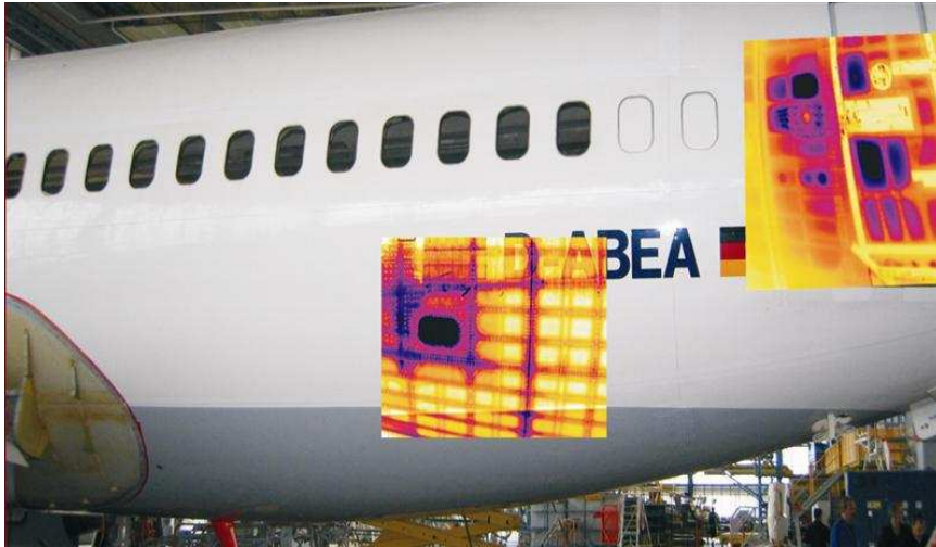
Bild 7: Ergebnisbildern einer Rumpfindspektion
