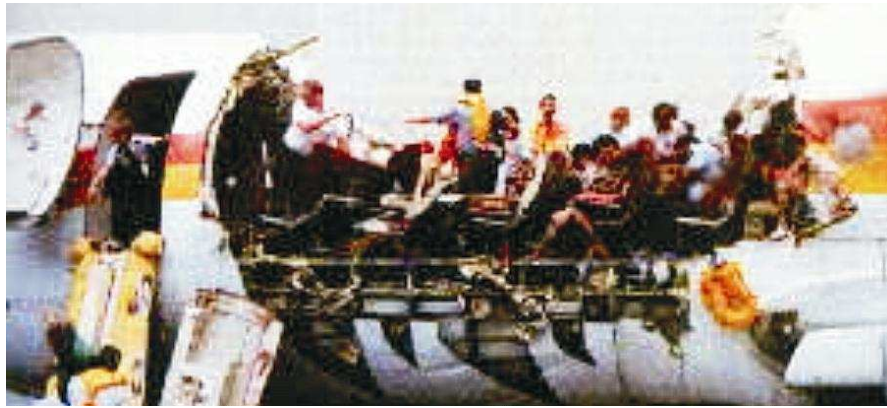
Bild 5: Flugzeug mit teilweise aufgerissenem Rumpf als Folge von Materialversagen
