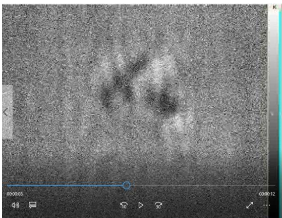
Bild 4: NIDIT-Anzeige der ebenen Diele 2 im Bereich des Spaltrisses
