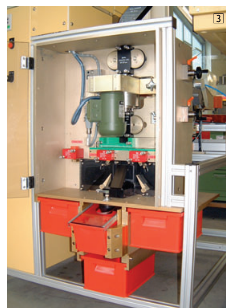
Bild 2+3: Prüfanlagen für Zylinderrollen und Nadeln.
